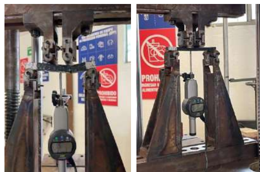
Figura 2. Ensayos a flexión pura con ayuda de un soporte con 4 puntos de aplicación de carga. Fuente: Elaboración propia.
