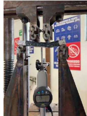
Figura 4. Prueba a flexión pura del espécimen E_I 1B. Fuente: Elaboración propia.
