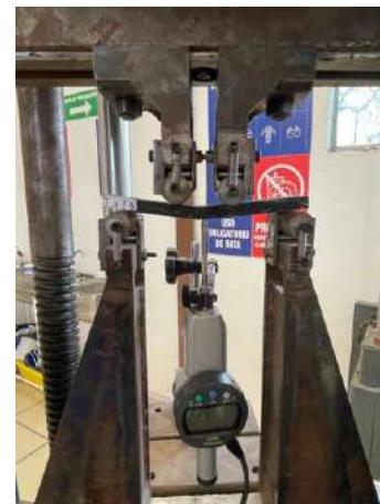
Figura 14. Prueba a flexión pura del espécimen E_III 3C.
