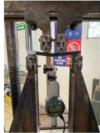
Figura 10. Prueba a flexión pura del espécimen E_II 2B. Fuente: Elaboración propia.
