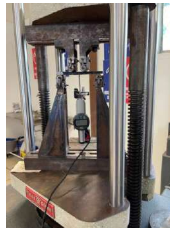
Figura 8. Prueba a flexión pura del espécimen E_II 2ª. Fuente: Elaboración propia.
