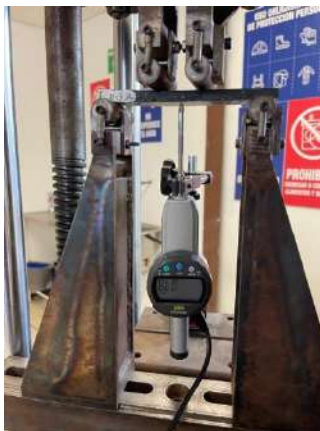
Figura 12. Prueba a flexión pura del espécimen E_II 2A.
