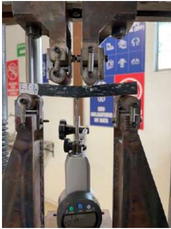
Figura 6. Prueba a flexión pura del espécimen E_I 1C. Fuente: Elaboración propia.
